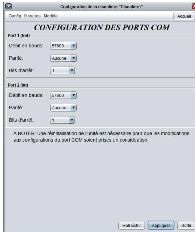
Figure 37 - Fenêtre de configuration des ports COM
