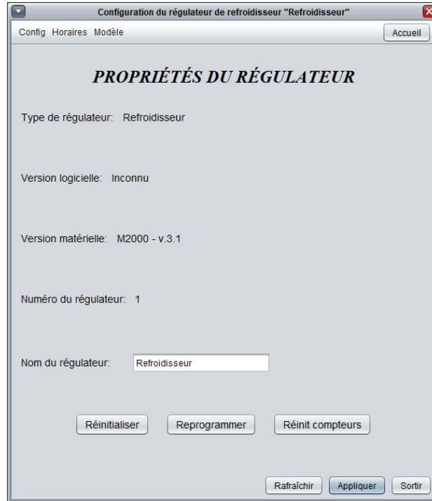
Figure 39 - Fenêtre des propriétés du régulateur
