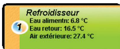
Figure 4 - Icône du régulateur de refroidisseur
