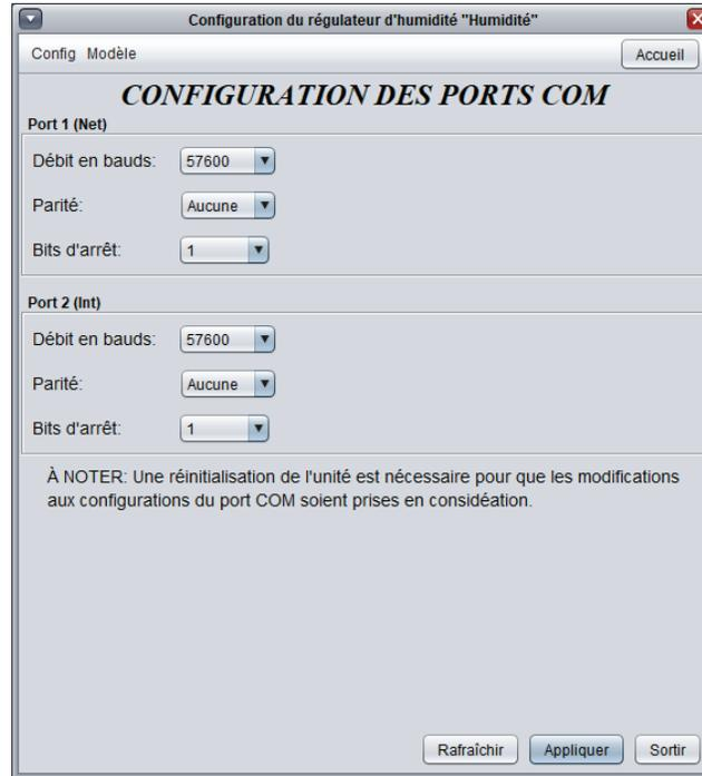
Figure 22 - Fenêtre de configuration des ports COM
