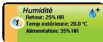
Figure 4 - Icône typique de régulateur d'humidification
