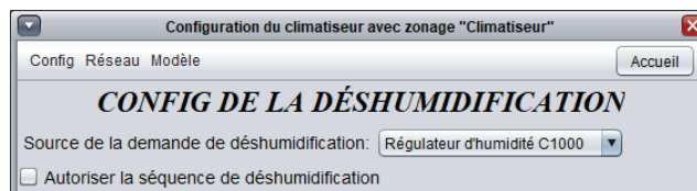
Figure 72 - Fenêtre de Configuration de déshumidification (à l'aide du régulateur PL-C1000-HU)
