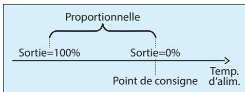
Figure 46 - Fenêtre de bande proportionnelle du préchauffage
