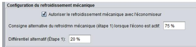
Figure 67 - Fenêtre de configuration du refroidissement mécanique
