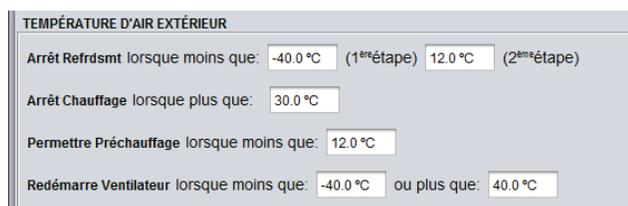
Figure 83 - Fenêtre de limites de température d'air extérieur
