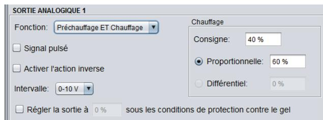
Figure 42 - Fenêtre de configuration de la sortie analogique 1
