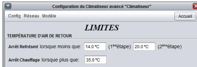
Figure 82 - Fenêtre de limites de température d'air de retour
