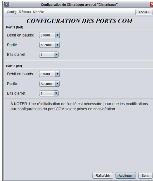
Figure 91 - Fenêtre de configuration des ports COM
