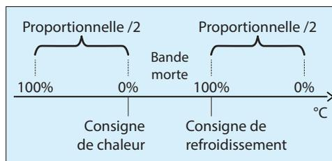
Figure 54 - Fenêtre de bande proportionnelle de boucle PI
