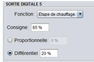
Figure 39 - Fenêtre de configuration de la sortie digitale 5
