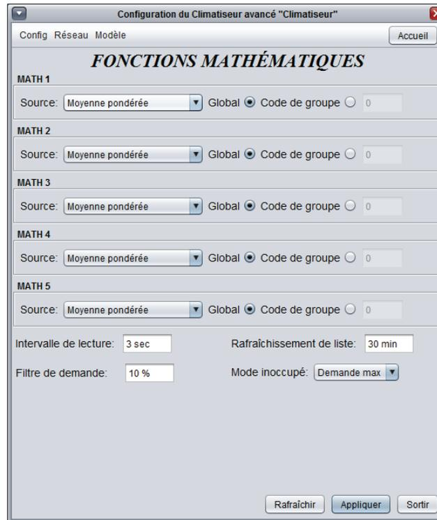
Figure 89 - Fenêtre de configuration des fonctions mathématiques
