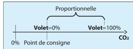
Figure 70 - Fenêtre de bande proportionnelle de CO<sub>2</sub>
