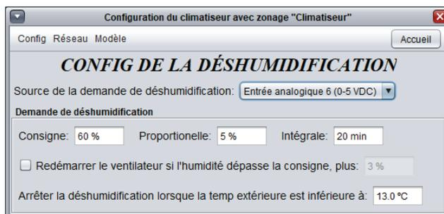
Figure 73 - Fenêtre de Configuration de déshumidification (à l'aide de l'entrée analogique 6, transmetteur d'humidité 0-5 VDC)
