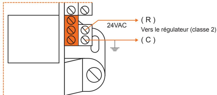
Figure 16 - Raccordement de la source d'alimentation 24 VAC
