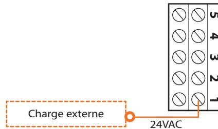
Figure 14 - Exemple de raccordement de la sortie digitale 1
