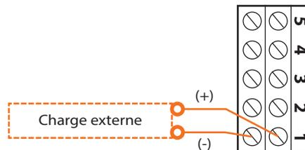
Figure 15 - Exemple de raccordement pour la sortie analogique 1
