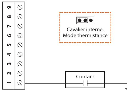
Figure 11 - Raccordement d'un contact sec à l'entrée analogique 1
