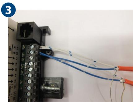
Apparier les conducteurs isolés, torsader ensemble, et installer sous les vis de borniers de communication. **Note** : Il ne devrait jamais y avoir plus de 2 fils de communication installés sous une seule vis.
