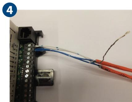
Torsader les câbles blindés ensemble pour former une bonne connexion électrique.
