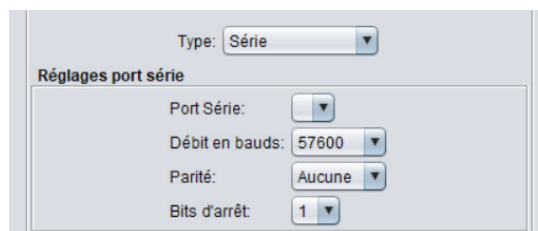
Figure 18 - Connexion à un port série
