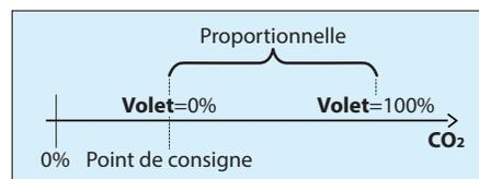
Figure 76 - Fenêtre de bande proportionnelle de CO<sub>2</sub>
