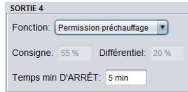
Figure 41 - Fenêtre de configuration de la sortie digitale 4
