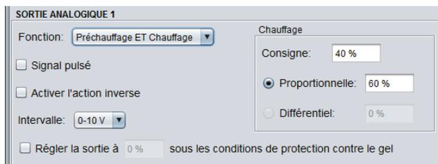
Figure 46 - Fenêtre de configuration de la sortie analogique 1
