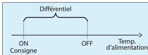
Figure 53 - Différentiel de basse limite d'alimentation
