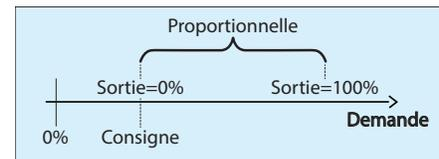
Figure 45 - Différentiel de contrôle du chauffage selon la demande
