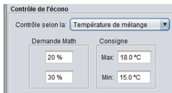
Figure 70 - Fenêtre de configuration de la température de mélange de l'économiseur
