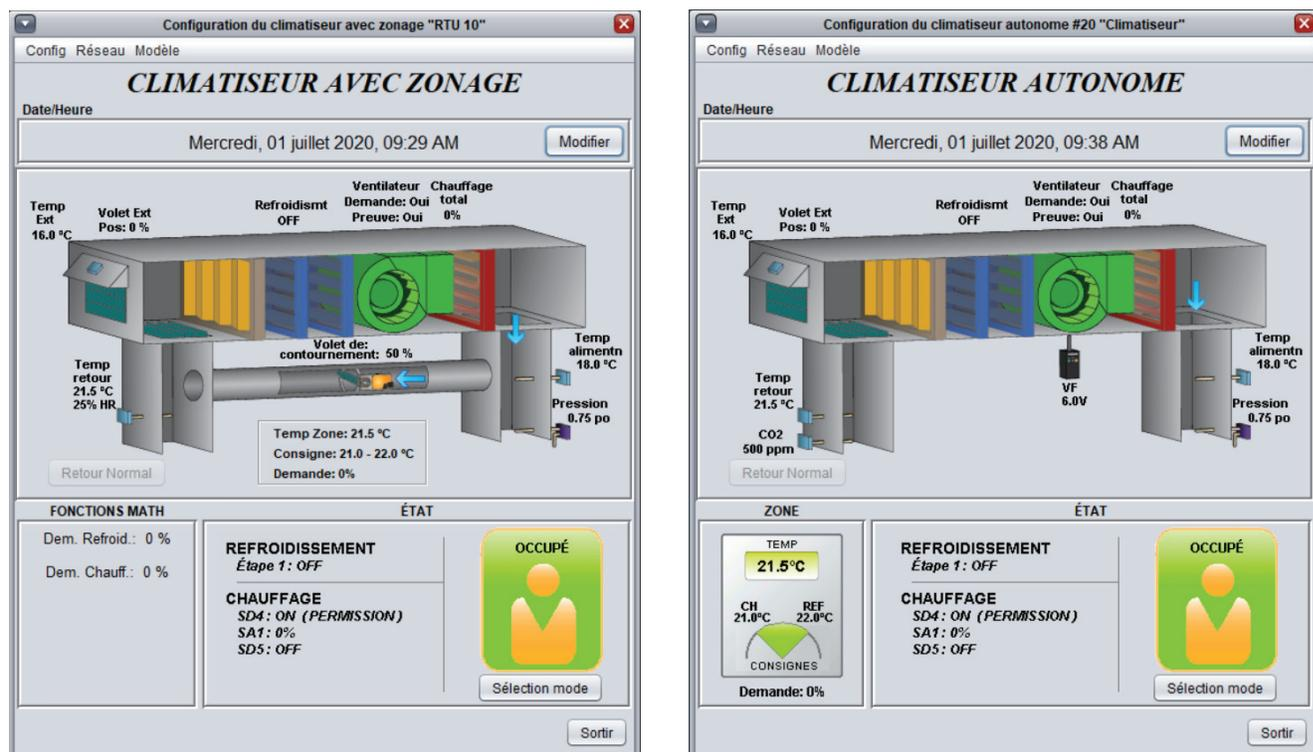
Figure 12 - Fenêtre d'accueil du régulateur de climatiseur
