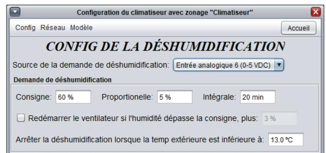
Figure 79 - Fenêtre de Configuration de déshumidification (à l'aide de l'entrée analogique 6, transmetteur d'humidité 0-5 VDC)
