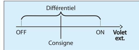
Figure 22 - Séquence de ventilateur d'évacuation mécanique
