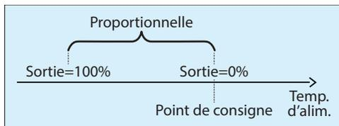
Figure 50 - Fenêtre de bande proportionnelle du préchauffage
