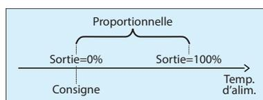
Figure 36 - Composante proportionnelle de la boucle PI du refroidissement analogique
