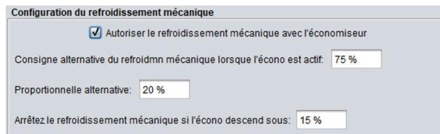
Figure 73 - Fenêtre de configuration du refroidissement mécanique
