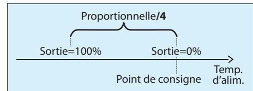
Figure 55 - Basse limite d'alimentation - bande proportionnelle analogique
