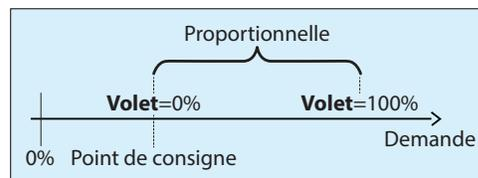
Figure 68 - Fenêtre de bande proportionnelle du volet de l'économiseur
