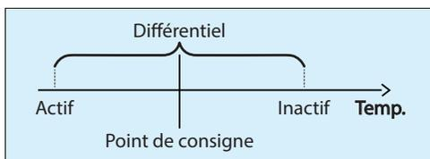
Figure 64 - Configuration de l'économiseur en mode bulbe sec
