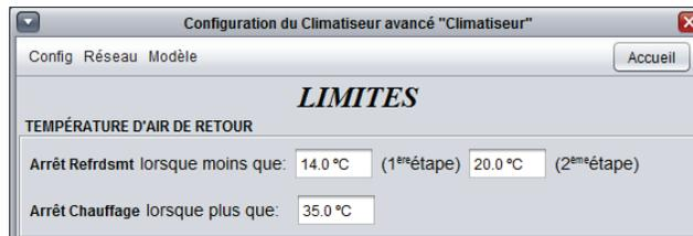
Figure 88 - Fenêtre de limites de température d'air de retour
