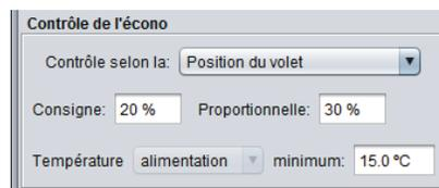
Figure 67 - Fenêtre de configuration de la position du volet de l'économiseur
