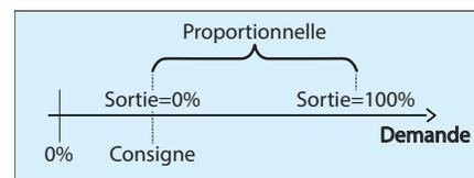
Figure 48 - Proportionnelle de contrôle du chauffage selon la demande
