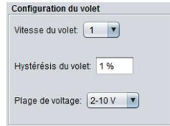
Figure 71 - Fenêtre de configuration du volet de l'économiseur
