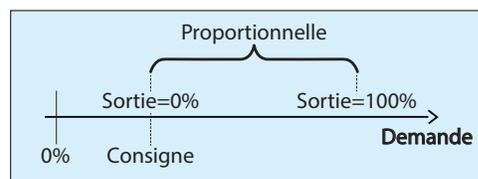
Figure 83 - Fenêtre de déshumidification analogique selon la demande
