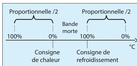
Figure 58 - Fenêtre de bande proportionnelle de boucle PI
