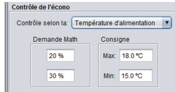
Figure 69 - Fenêtre de configuration de la température d'alimentation de l'économiseur
