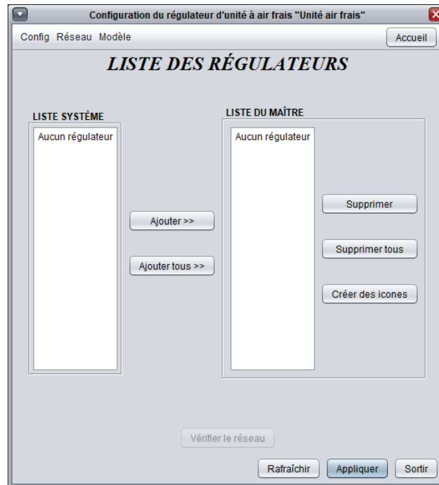
Figure 44 - Fenêtre de liste des régulateurs
