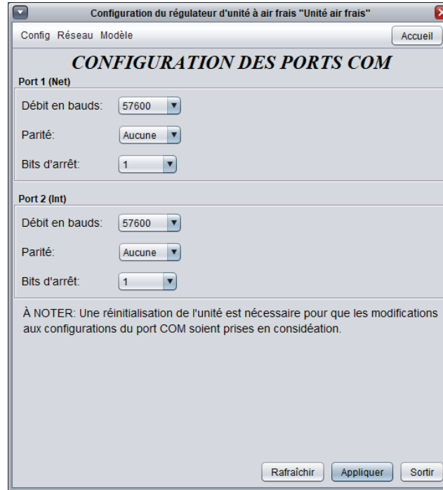
Figure 45 - Fenêtre de configuration des ports COM
