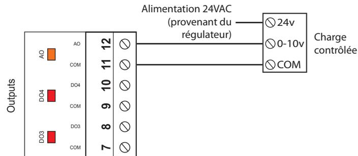
Figure 12 - Raccordement de la sortie analogique (alimenté par le régulateur)
