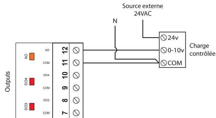
Figure 13 - Raccordement de la sortie analogique (alimentation externe)
