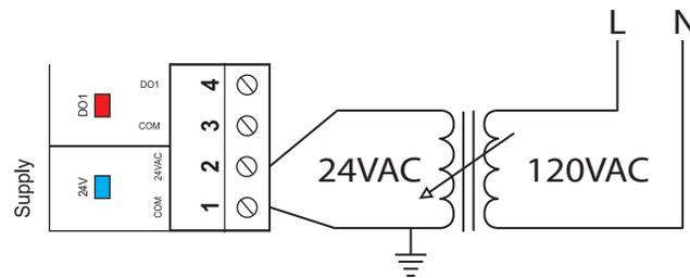
Figure 14 - Raccordement de la source d'alimentation 24 VAC
