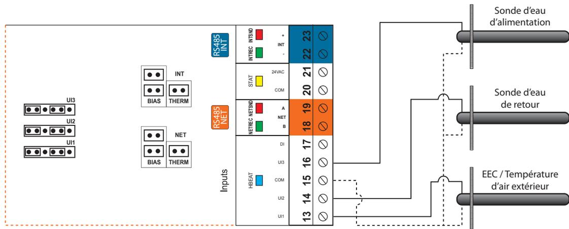
Figure 6 - Raccordement des sondes de température
