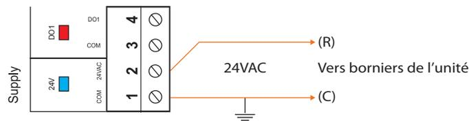
Figure 13 - Raccordement de la source d'alimentation 24VAC
