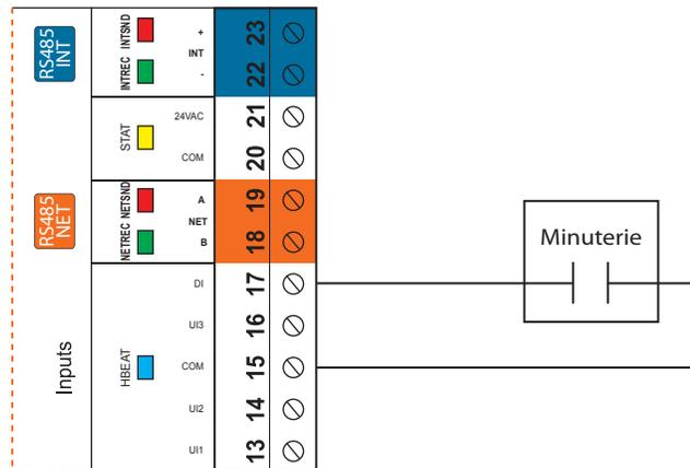
Figure 7 - Connexion du contact d'abaissement de nuit
