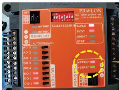
Figure 5 - NETSND/NETREC sur un M2000
