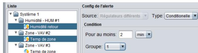
Figure 38 - Exemple d'une configuration multiple
