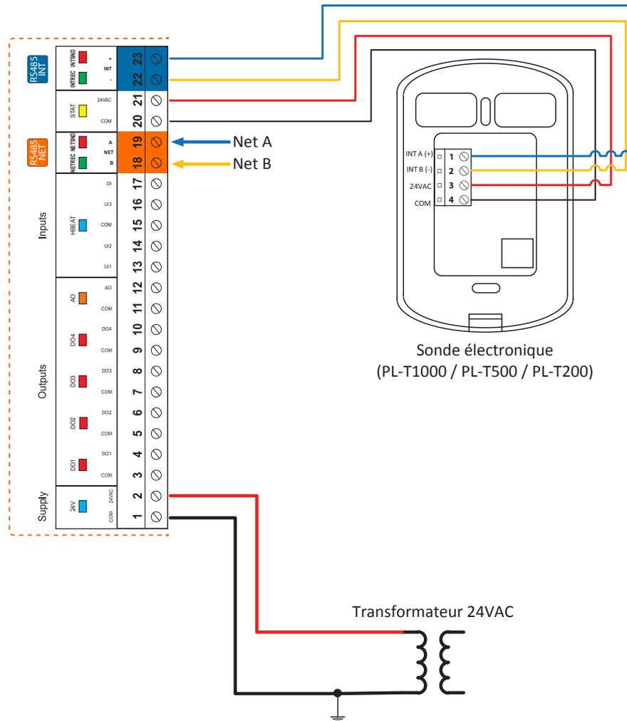
**Câblage recommandé pour la communication:** #24/2, mulbrins, torsadés et protégé, à faible capacitance.
