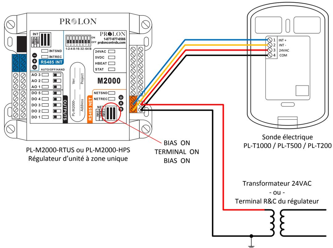
**Câblage recommandé pour la communication:** #24/2, multibrins, torsadés et protégé, à faible capacitance.
