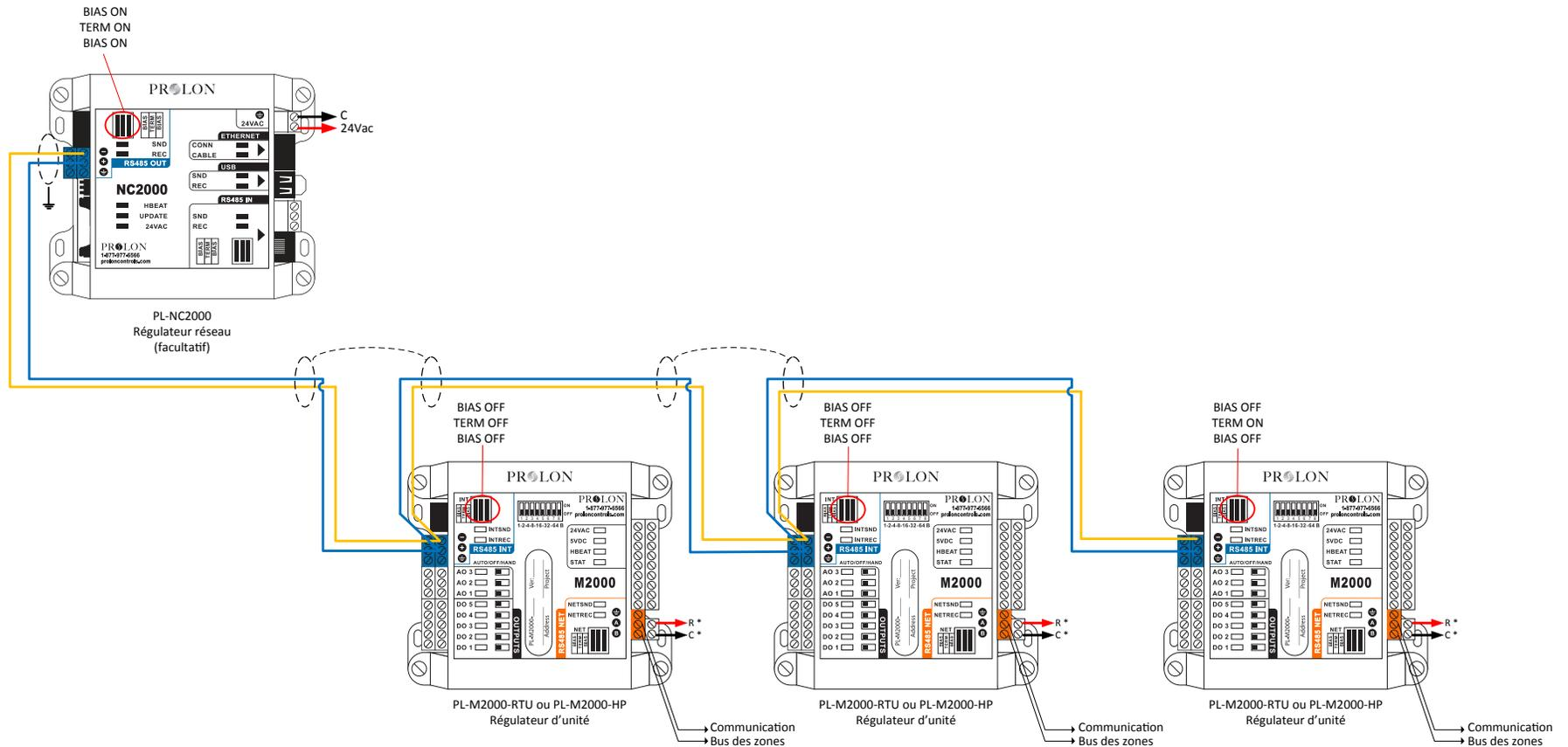
**Câblage recommandé pour la communication:** #24/2, multibrins, torsadés et protégé, à faible capacitance.
