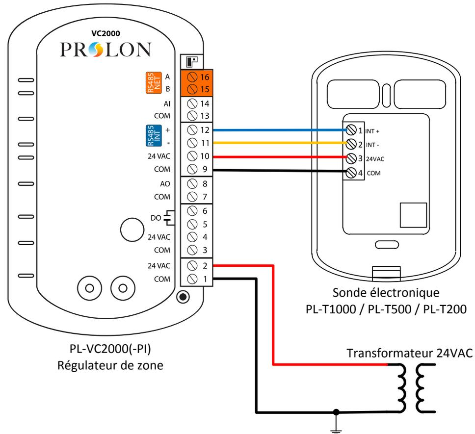
**Câblage recommandé pour la communication:** #24/2, multibrins, torsadés et protégé, à faible capacitance.
