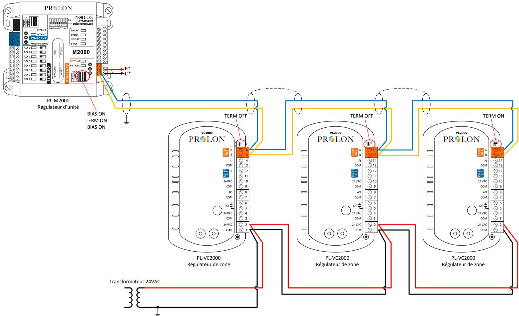
**Câblage recommandé pour la communication:** #24/2, multibrins, torsadés et protégé, à faible capacitance.
